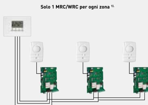
1) Fino a 15 Plogic/unità interne idroniche. Le unità interne idroniche possono essere di diversi tipi, con motore ventilatore AC o EC.
